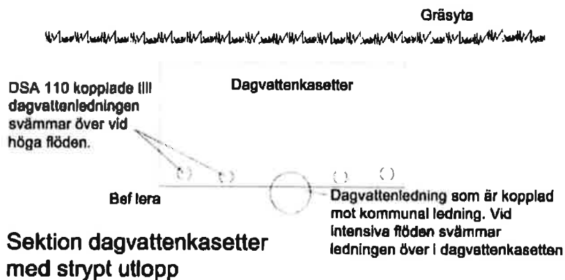
Bild 10. Exempel på dagvattenkassetter
