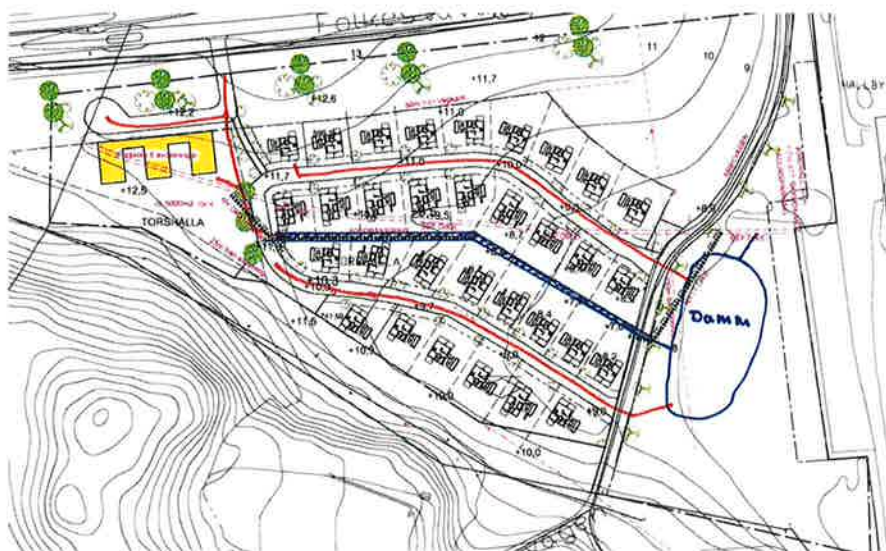
Bild 6. Förslag på hantering av dränering samt dagvatten från gator
